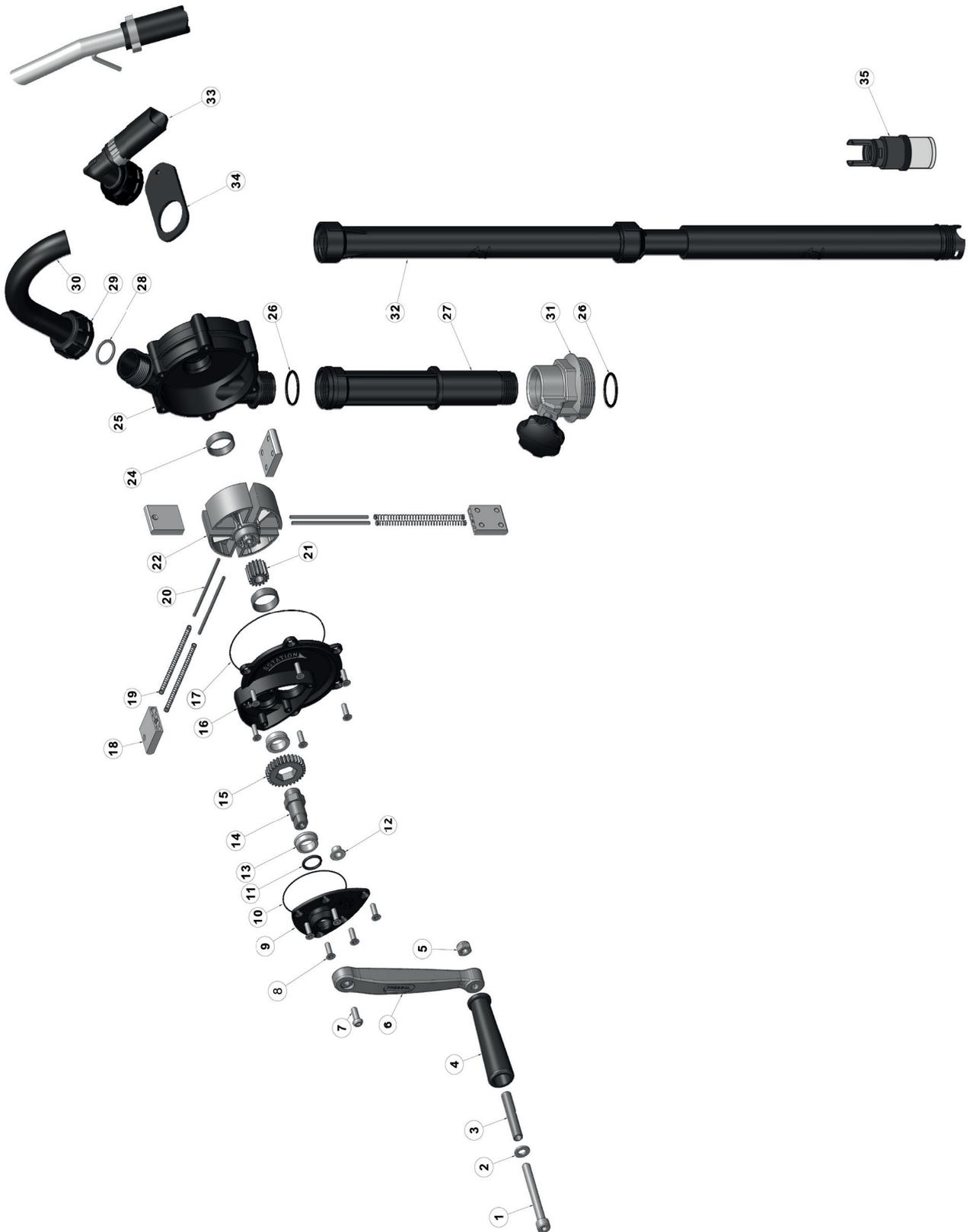
Рис. 9-1: Покомпонентное изображение роторного насоса
